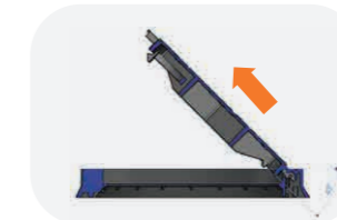
Під кутом 45°, за умови демонтованої захисної скоби – кришка витягується з корпусу люка
