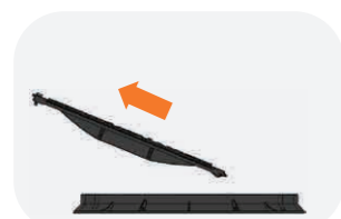
Кут при якому з демонтованою захисною скобою – кришка витягується з корпусу люка
