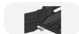
Замість арматури можна використовувати болти або шпильки від L=70 мм
