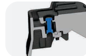
Фіксація кришки болтами в закритому стані
