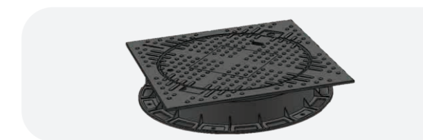
Опорна підставка з самонівелюючим квадратним люком. Висота люка без опорної підставки – 100 мм. Мінімальна висота люка з опорної підставкою – 150 мм Максимальна висота люка з опорної підставкою – 200 мм
